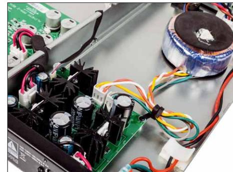
Wie auch die Versorgungsspannungen für die Schaltung ist das Netzteil geregelt. Der Ringkerntrafo wird für Elac gebaut
